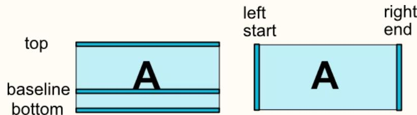
Toutes les contraintes right/left ont été remplacées par des contraintes End/Start dès API 17. End/Start facilitent l'adaptation des interfaces aux UI RTL.
